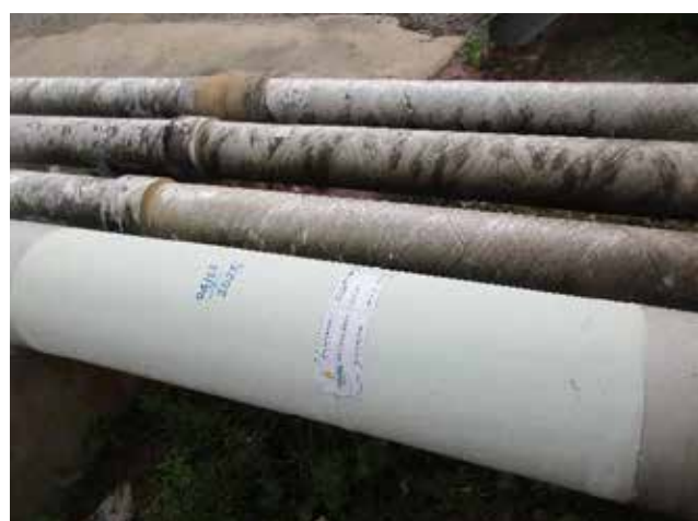
Hình 11. Kết quả thử nghiệm lớp phủ epoxy thông minh tại khu vực đường ống công nghệ U34 (VT2) của Nhà máy Lọc dầu Dung Quất sau 8 tháng.
